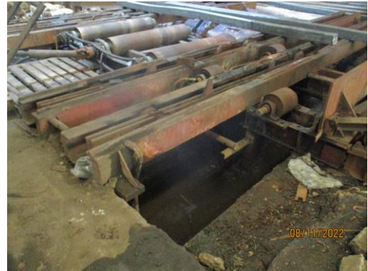
รูปที่ 14 บ่อคอนกรีตบริเวณแท่นลวดอุณหภูมิ
